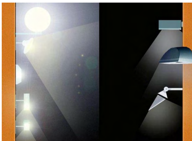
Une bonne orientation du flux lumineux évite l'éblouissement et les pertes de lumière
