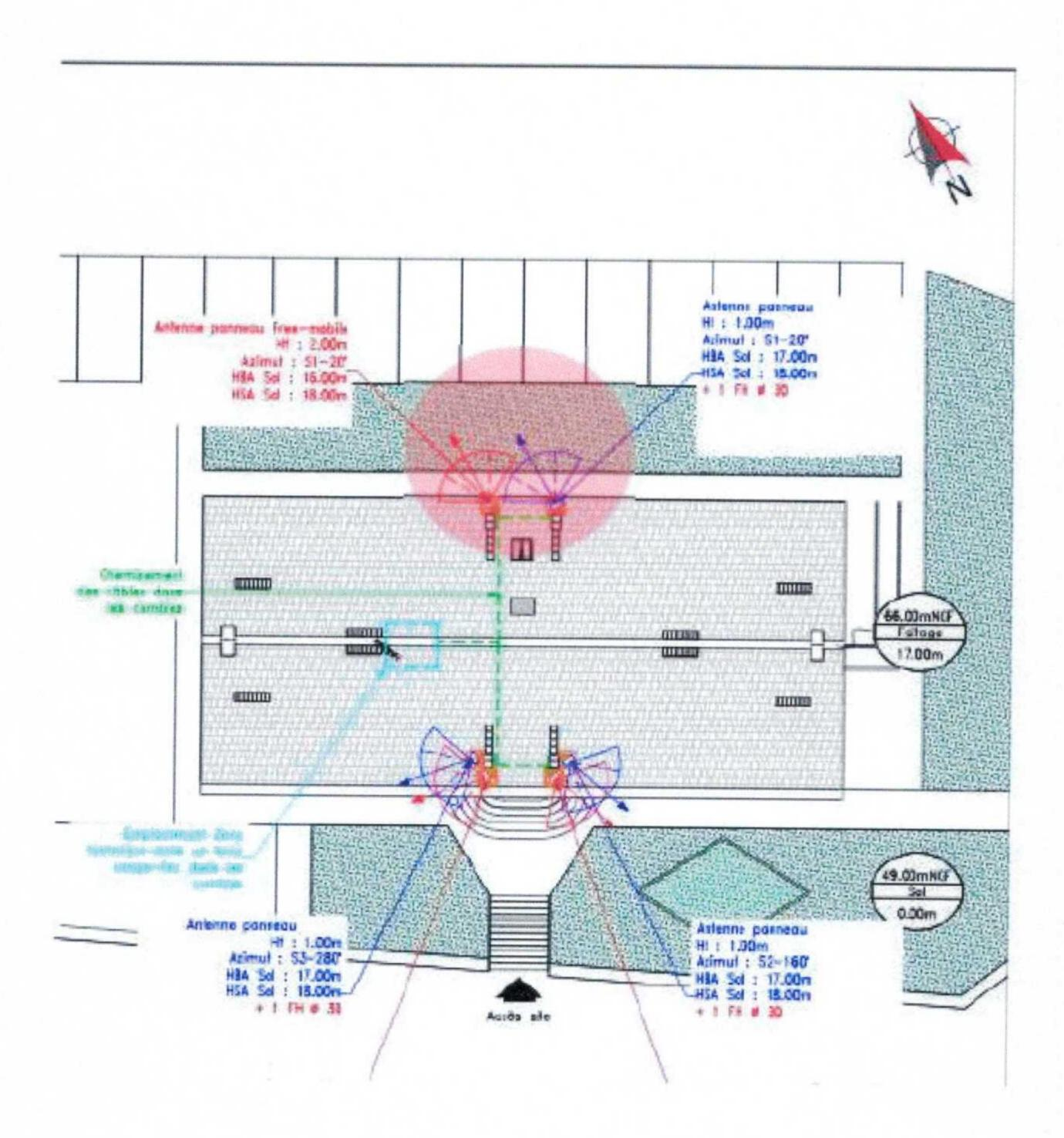
En superposant une partie du plan, ci-dessus, sur l'application Googlearth, on constate que l'azimut de cette antenne serait d'environ 356°, ce qui met le faisceau de cette dernière dans le bâtiment situé à l'ouest du site (Voir la photo montage Etude-free-Montgeron\_1.jpg avec l'azimut en rouge).
