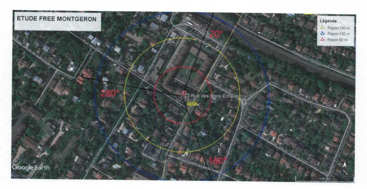
Nous avons fait quelques calculs sur les impacts d'exposition aux champs électromagnétiques selon les données du tableau (page 10/49), par propagation en <u>espace libre (sans obstacle)</u> dans l'axe d'une antenne.
